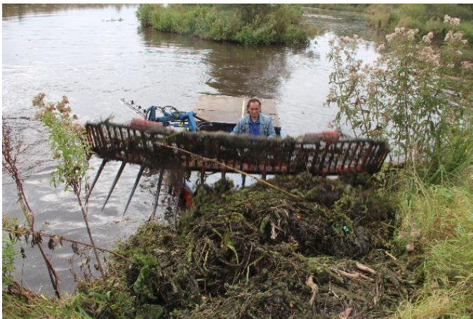
Met veegboot cabomba op de kant leggen
